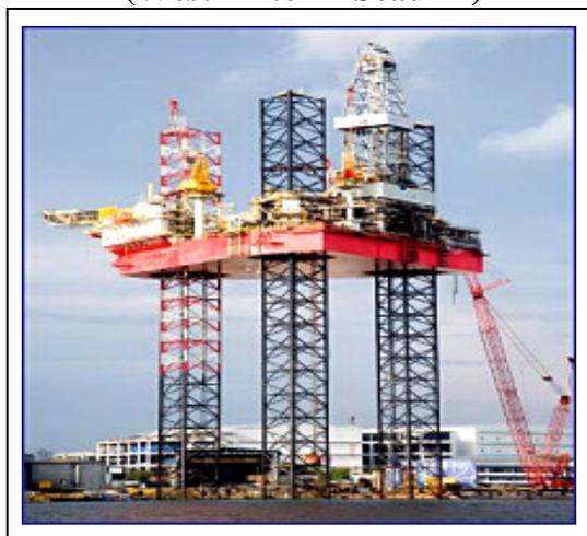
Nota: Plataforma com capacidade de perfuração a cerca de 100 m de lâmina entregue no início de 2008 pelo estaleiro PPL Shipyard, da Sembcorp Marine (Cingapura).
